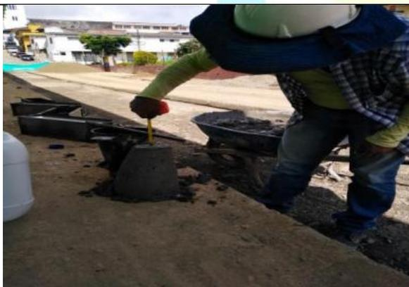
Prueba de asentamiento del concreto 2-10-2020
